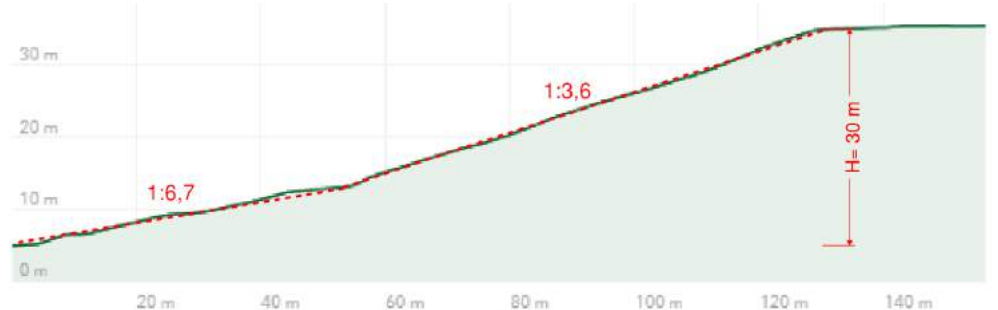
Figur 5-3: Snitt 1 fra høydedata som viser terrenghelning og skråningshøyde.
