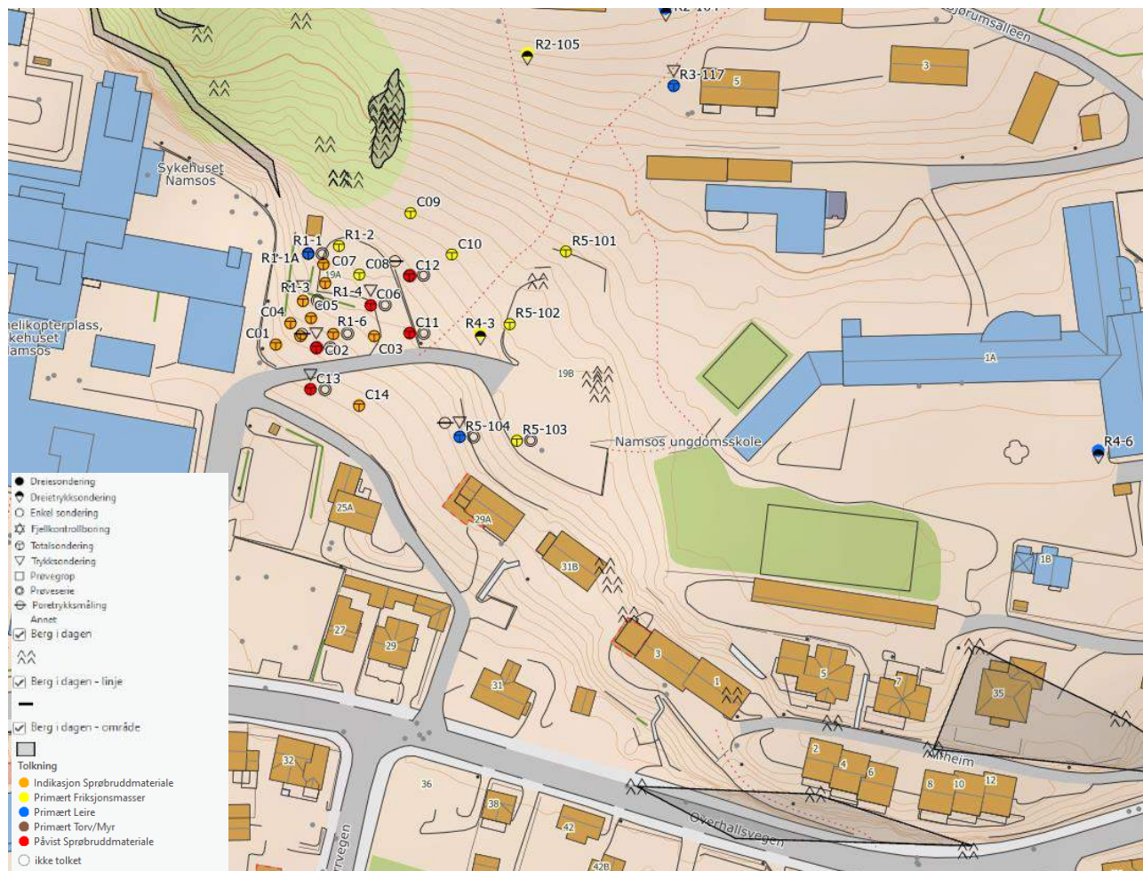
Figur 5-8: Berg i dagen registrert på befarig.
