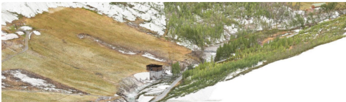
Figur 1-10. Modellbildene viser planlagt tyrolerinntak med tilliggende kraftstasjon ved Skogli. Ny bru over Indre Offerdalselvi synes best i utsnittet nederst, sett i fugleperspektiv fra sørvest, der ein ser over skogen.
