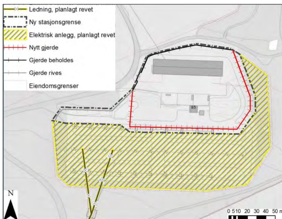
Figur 1-1: Oversikt over de deler av Stølaheia transformatorstasjon samt 300 kV nettilknytning som er omsøkt revet. Figur hentet fra Statnetts konsesjonssøknad (Statnett, 2021).
