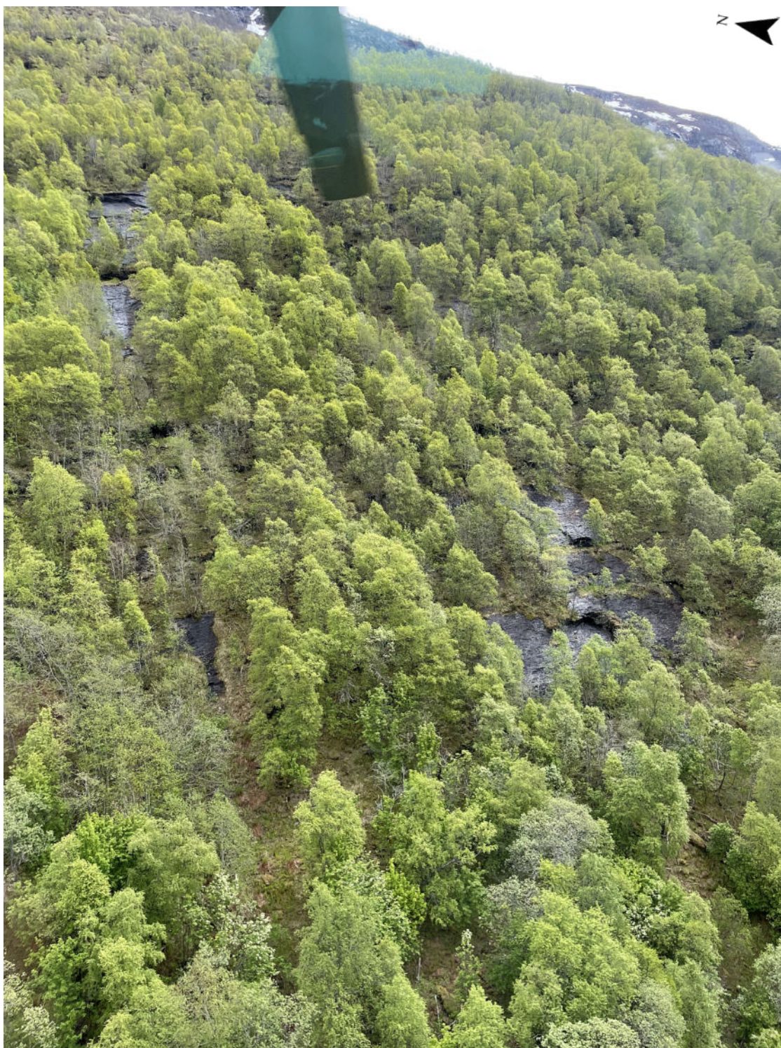
Figur 3-7. Fjellsiden i nedre del øst for dagens koplingsstasjon (her ca. 500-600 moh.) består av fyllitt. Berget har en skifrihet som gir tendens til å gli ut i flak slik som her er synlig fra tidligere utfall/sår.
