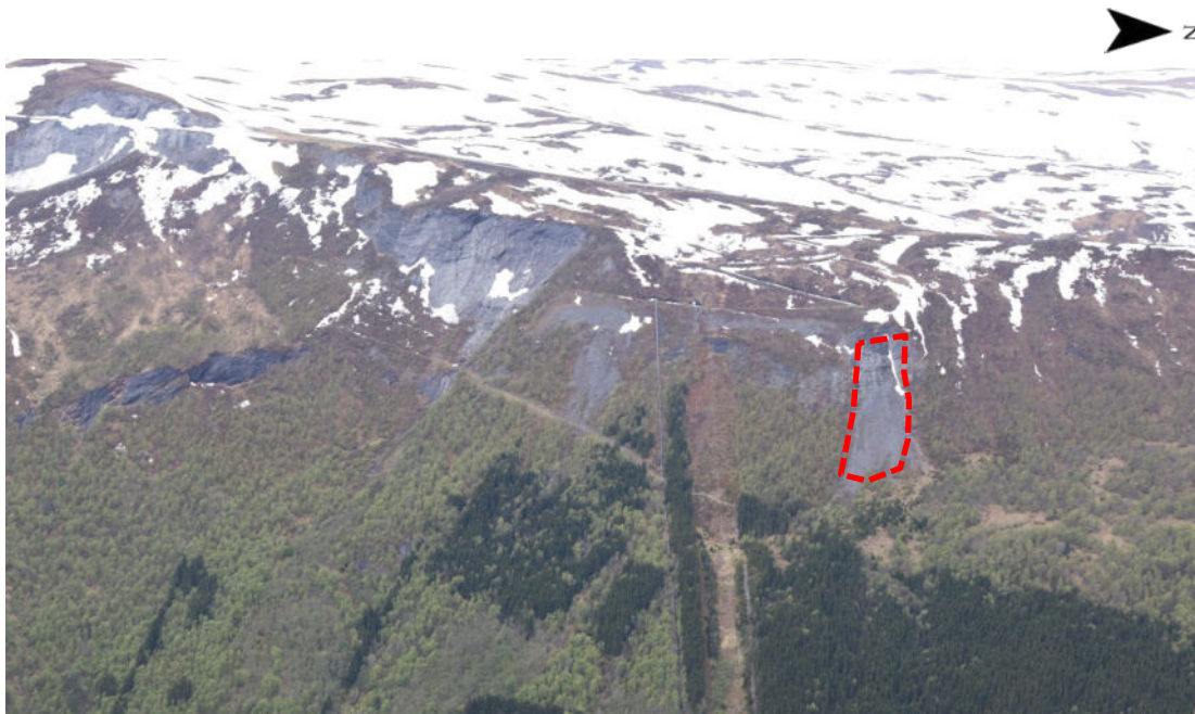
Figur 3-22 Svabergene er potensielle løseområder for snøskred. Nedenfor svaberget lengst nord i bildet ble det observert skader på trær etter snøskred. Rød stiplet linje angir løseområde som kan gi snøskred med retning mot Alternativ Sør.
