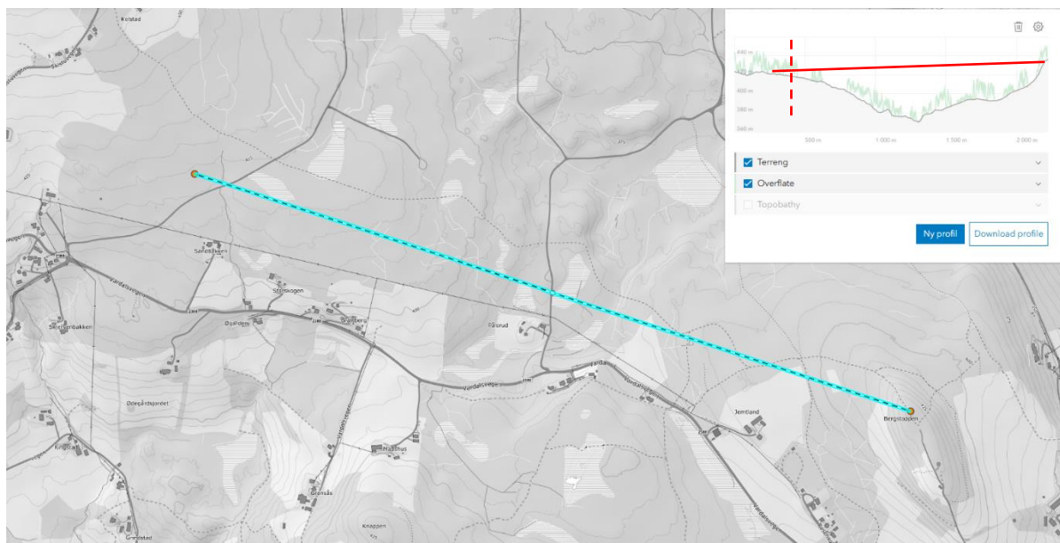
Figur 5-12. Snitt fra tiltaksområdet til Bergstoppen, med siktlinje. Skogen mellom de to områdene gir lite skjermingseffekt, med mindre den ligger tett på tiltaksområdet. Grensen til planområdet er markert med rød stiplet linje på utsnittet i øvre høyre hjørnet, og Bergstoppen er øverst til høyre i utsnittet i øvre høyre hjørne. Kilde: Høydedata, 2025.
