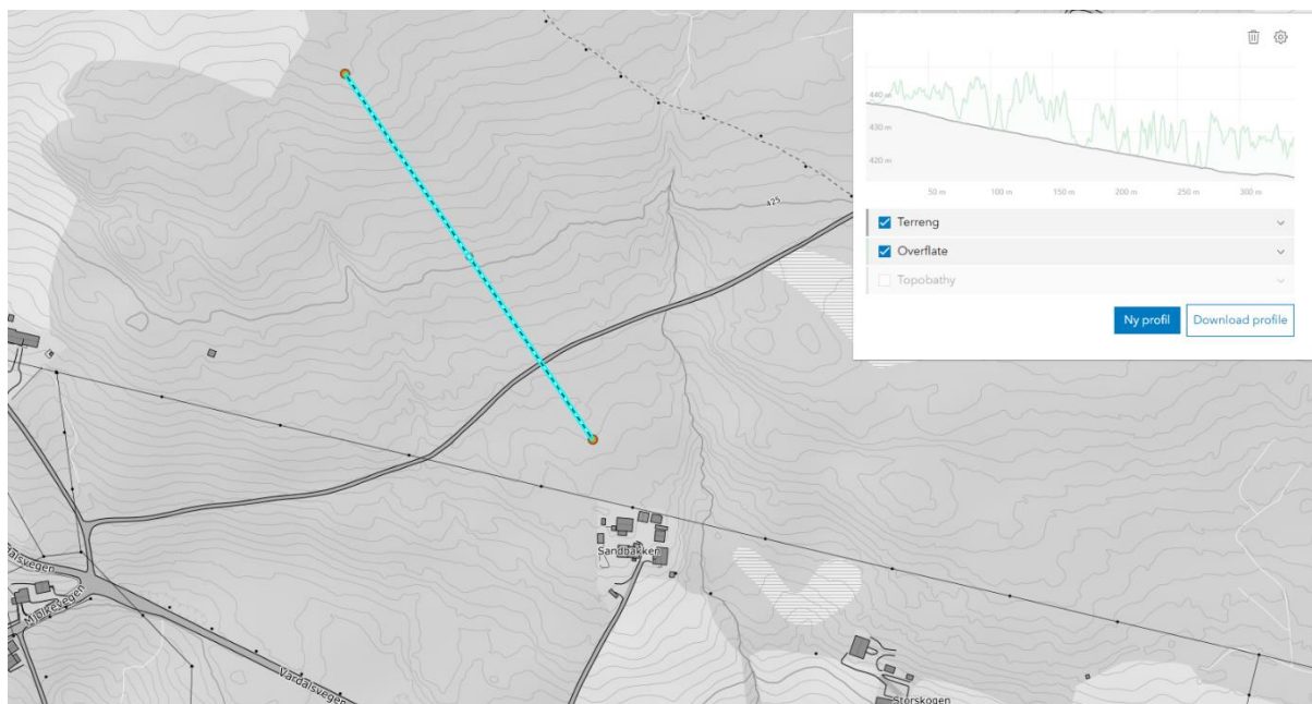
Figur 4-5. Profil i planområdet Mæhlum solkraftverk. Snitt viser terreng i grå og vegetasjon (eller overflate modell) i grønn. (Kilde: Høydedata.no, 2025)
