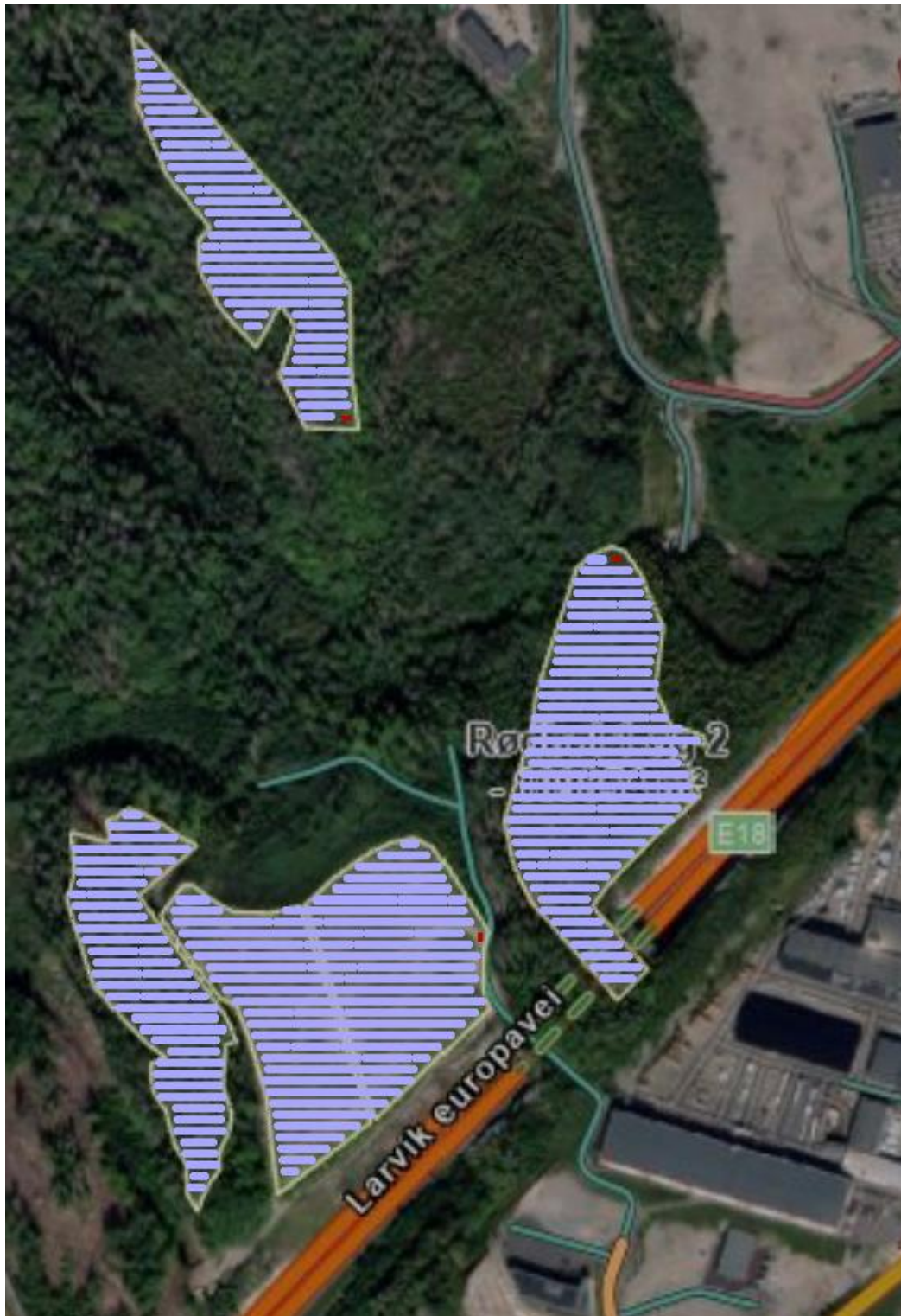
Figur 2-2: Grov skisse av solcelleanlegget med plassering av solcellepanelrader (lyseblått), transformator (røde rektangler) og hovedadkomstveier innad i anlegget (turkis). Designet viser maksimal utnyttelse av området. Hovedpunkt for tilknytning er foreløpig satt til nord-østlig side av parken.
