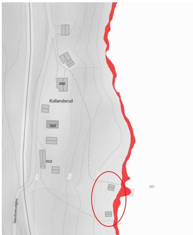
Figur 5-14 Areal som ligger 1 m over vannlinjen i Norefjorden vist med rødt. Påvirket areal ved hyppige vannstandsvariasjoner vil bli noe mindre enn det kartet viser, men kartutsnittet gir en indikasjon på lavtliggende områder ved Kollandsrud. Vannet kommer ganske nært verneverdige bygninger på Kollandsrud, på vestsiden av Norefjorden. Disse har elementer datert til 1600-tallet (markert med rød ring).
