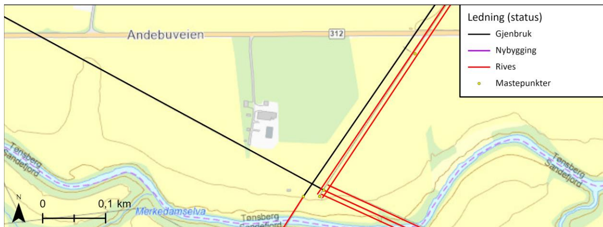
Figur 5-4 Alternativ 1 for 66 kV Tveiten-Kullerød etter ledningsomleggingene ved Kjerringhovet.
