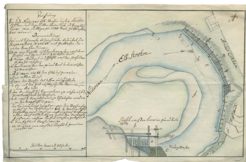
Figur 6.1 Plankart og skisse for sikring mot Nidelva ved Arildsløkken i Trondheim 1730.
