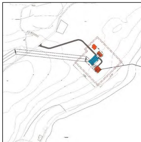
Figur 2-14. Skisse for mulige utforming av muffestasjonen ved Ytre Billefjord.
