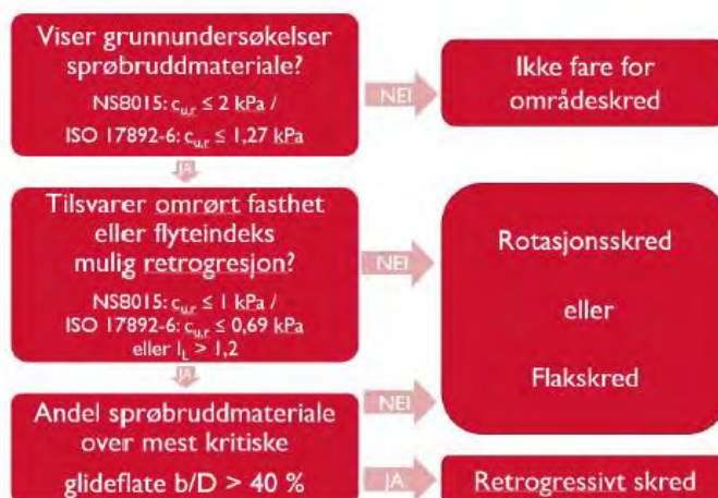
Figur 4.3 Flytskjema for vurdering av aktuell skredmekanisme
