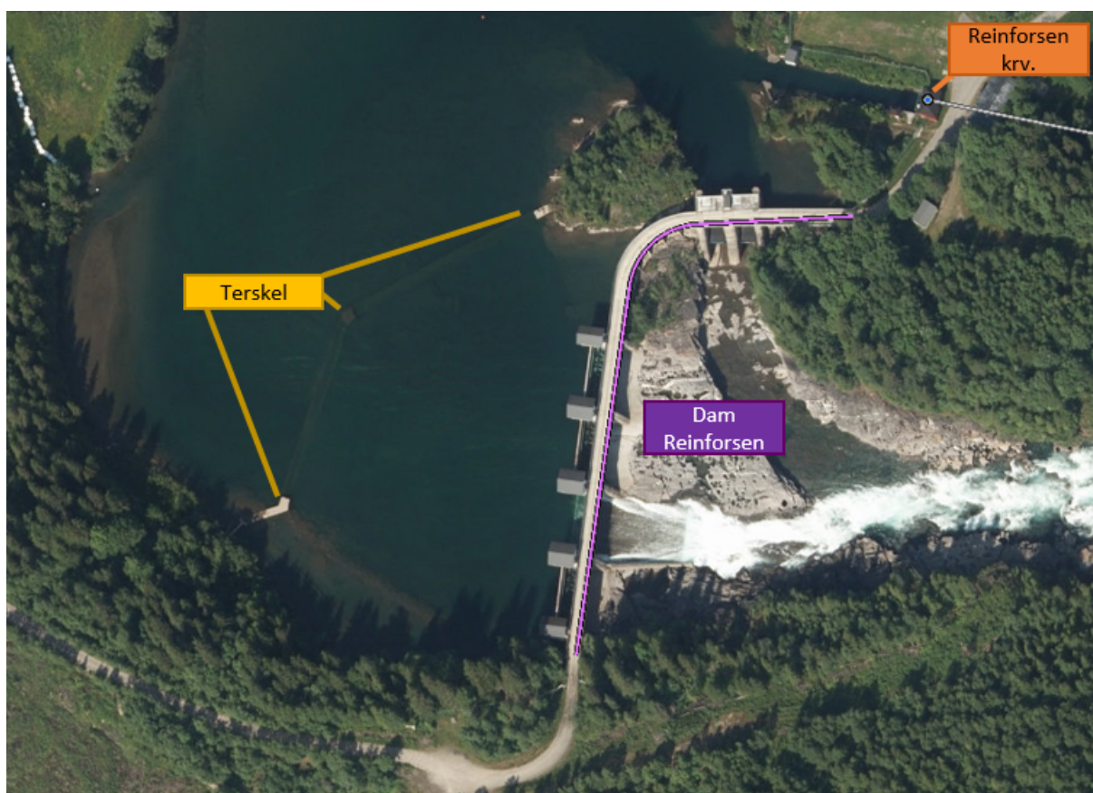
Figur 56: Rett oppstrøms dam Reinforsen ligger det en terskel som hadde større funksjon før dam Reinforsen ble bygget. Dens høyde tilsvarer laveste regulerte vannstand (LRV) i Langvatn. (Flyfotoet er hentet fra NVE-Atlas og er navnsatt av NVE).
