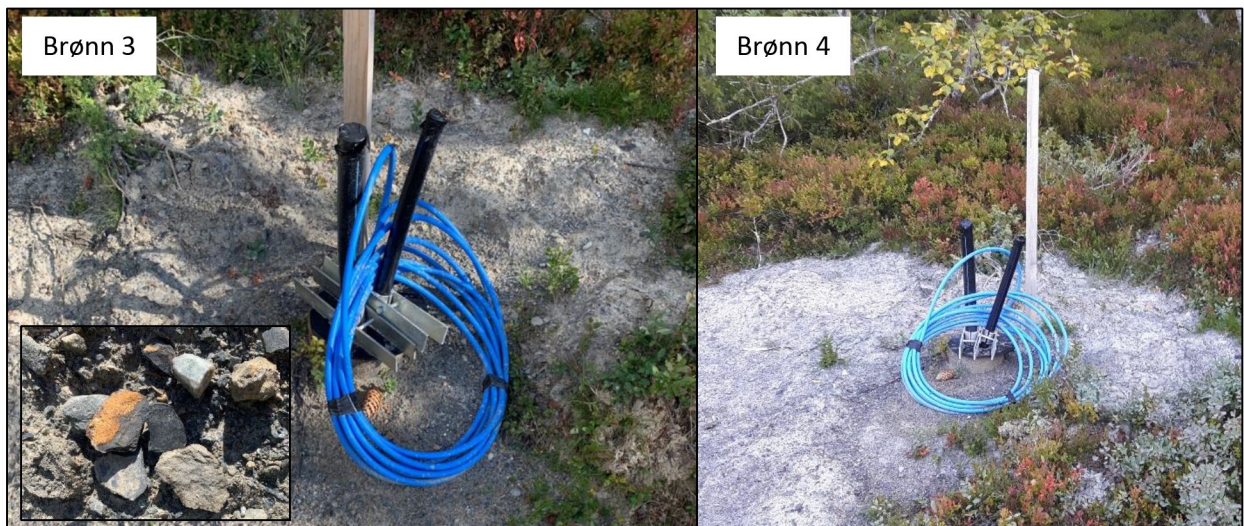
Figur 6. GB03 og GB04 er lokalisert i et område med morenemasser og ligger høyere i terrenget enn GB01 og GB02. Borkaks ved borhullene viser at GB03 delvis er boret gjennom skifrig berggrunn.
