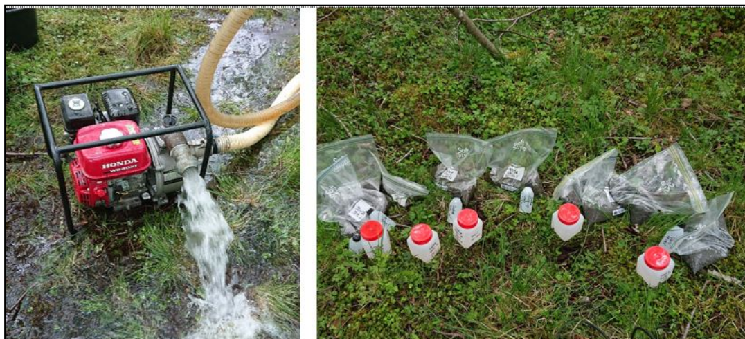
Figur 6. Testpumping av 5/4" undersøkelsesbrønn-1 (venstre) og uttatte sediment- og grunnvannsprøver.
