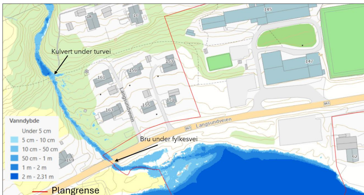
Figur 4-5: Oversikt over 200-årsflom med 40% klimapåslag ved 1-års stormflo inkl. havnivåstigning.
