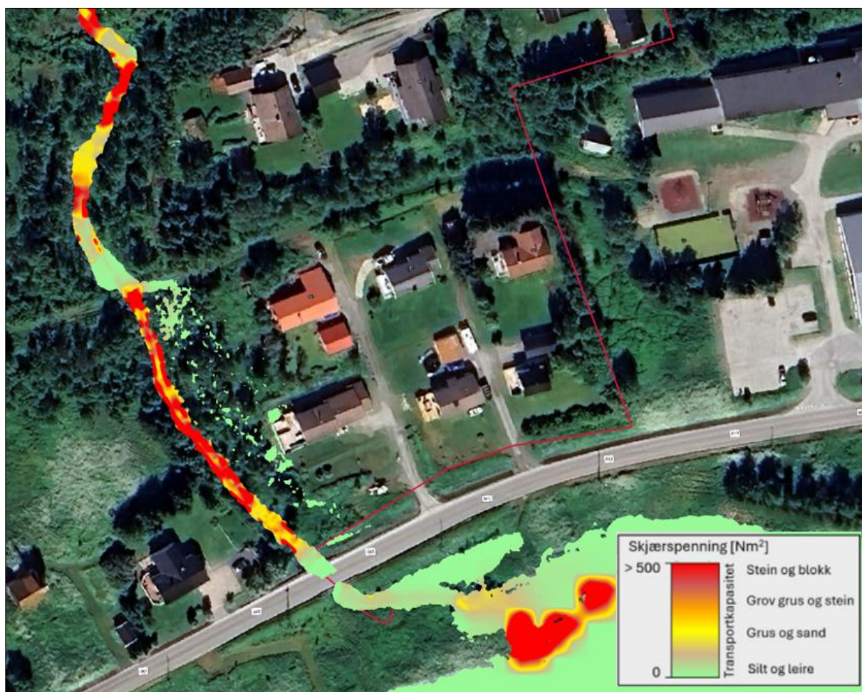
Figur 6-3: Oversikt over maksimal skjærspenning i elva ved dimensjonerende flomhendelse.
