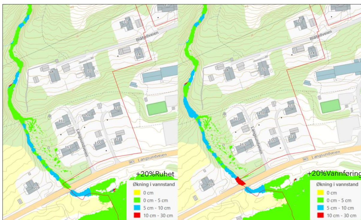
Figur 4-7: Resultater fra følsomhetsanalyser, det ruhet og vannføring er økt med +20%.
