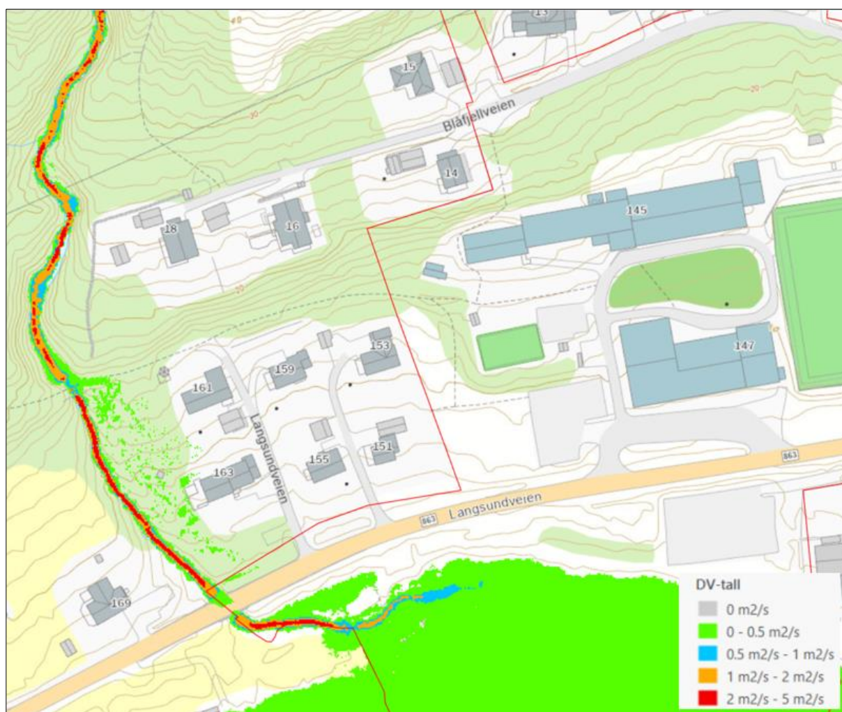
Figur 6-2: Oversikt over maksimale DV-tall ved dimensjonerende flomhendelse.
