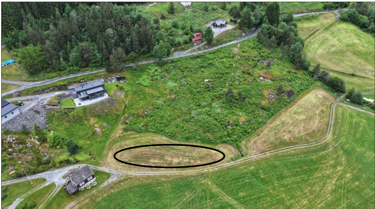
Figur 11: Dronebilete viser fleire fjellblottingar i midtre del av kartleggingsområdet, og lausmassedekket i kartleggingsområdet og påverknadsområdet er vurdert å hovudsakleg vere mindre enn 0,5 meter tjukt. Djupnemåling på innmarka rett nedanfor (svart markering) viser ei maks djupne på 0,67 meter til fjell/harde massar (Figur 24). Infopunkt 3.
