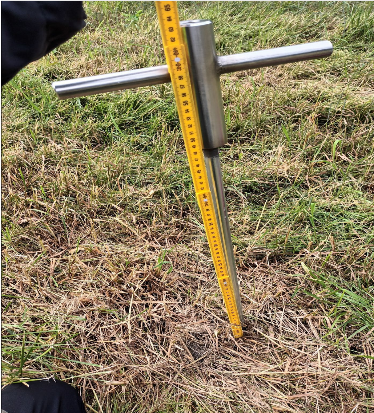
Figur 24: Det vart utført fleire stikkprøver med boniteringspinne på innmarka i austleg del av kartleggingsområdet. Djupaste målte punkt var på 0,67 m før det blei treffe på fast fjell/harde massar. Boniteringspinnen måler 115 cm opp til skaftet. Infopunkt 2.
