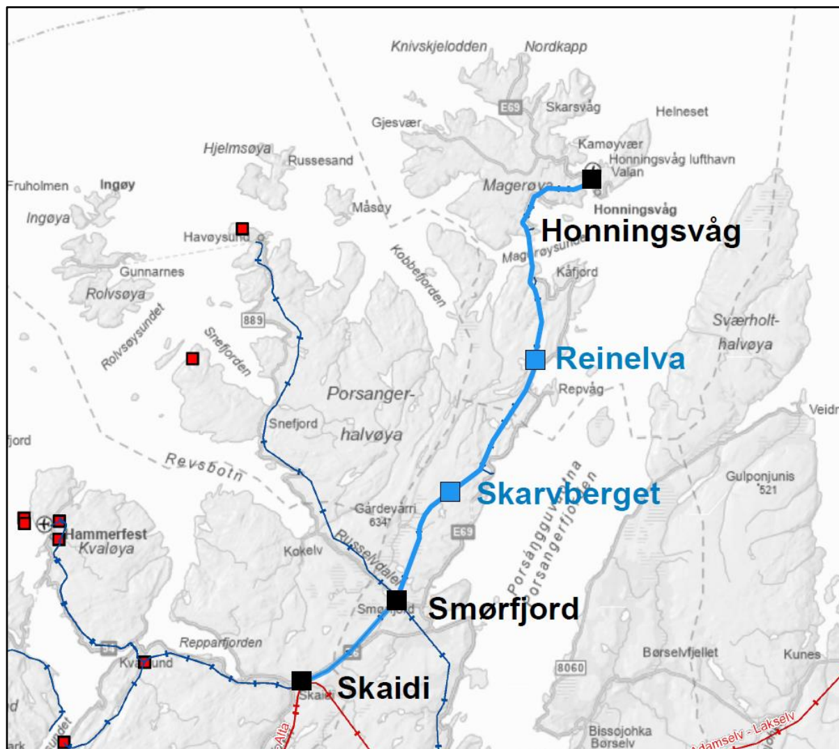
Figur 4-4: Oversiktskart fra nettmelding. Blå linjer viser eksisterende traseer som er meldt oppgradert til 132 kV. Svarte bokser er eksisterende trafostasjoner. Blå bokser er omtrentlig plassering for nye koblings-/trafostasjoner ved tilknytning av vindkraft.
