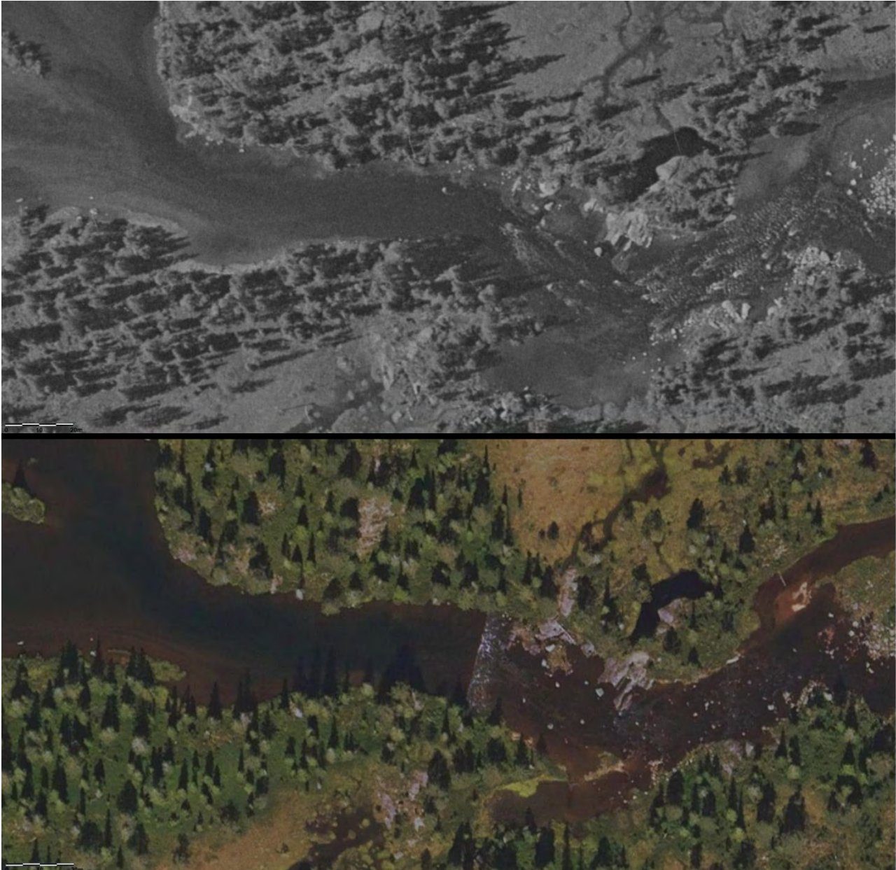
Figur 37. Sæbyggjeåi nedstrøms Grotstøylhylen. Foto øverst viser elvesegmentet uten terskel (1972), mens bildet under viser dagens situasjon. Foto er hentet fra www.norgebilder.no .
