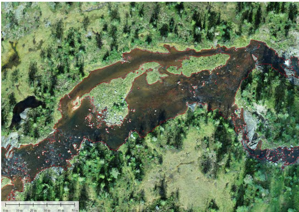
Figur 11. Simulert vanndekning (røde streker) og dronefoto tatt ved tilsvarende vannføring ( Q=1 \text{ m}^3/\text{s} ). Elveavsnitt fra sone 3.
