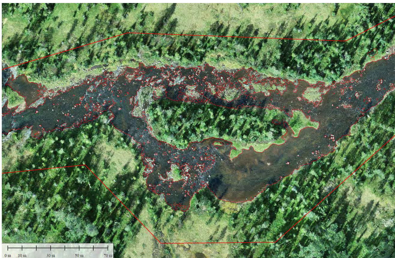
Figur 9. Simulert vanndekning (røde streker) og dronefoto tatt ved tilsvarende vannføring ( Q=1 \text{ m}^3/\text{s} ). Elveavsnitt fra sone 1.
