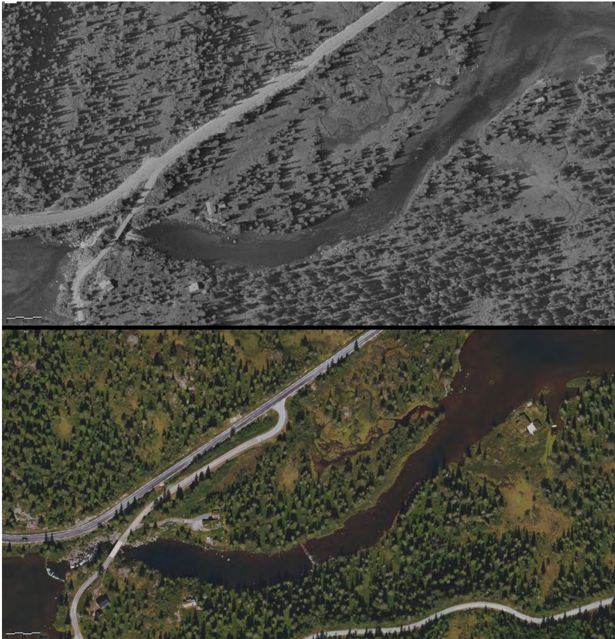
Figur 38. Sæbyggjeåi oppstrøms Grotstøylhylen. Foto øverst viser elvesegmentet uten terskler (1972), mens bildet under viser dagens situasjon. Foto er hentet fra www.norgebilder.no . Potensielt absolutt vandringshinder rett oppstrøms brukryssing i venstre billedkant. Det er mulig at terskelbygging her har endret vandringsforholdene.
