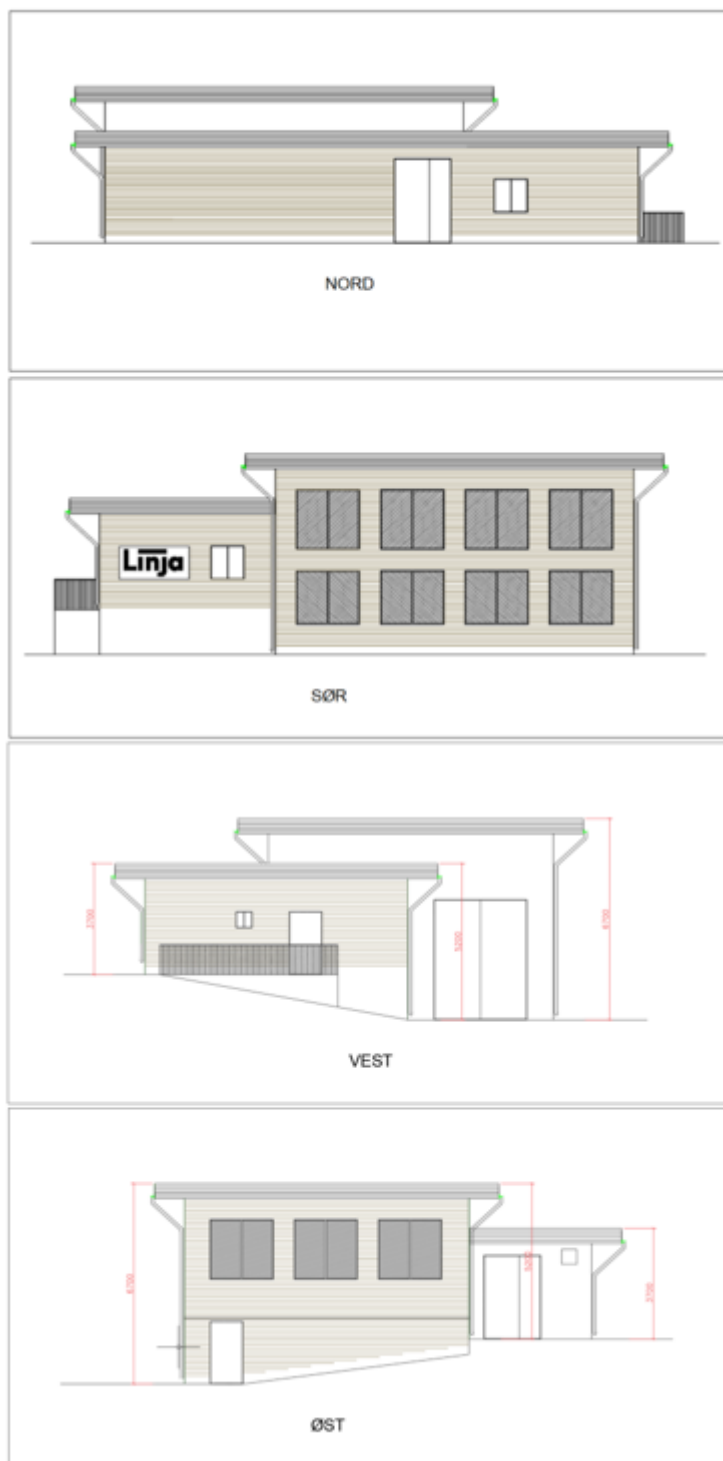
Figur 8 Fasadetegninger over omsøkt stasjonsbygg (5)
