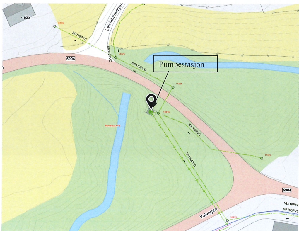
Figur 7 Avlopsledninger og tilhørende pumpestasjon
