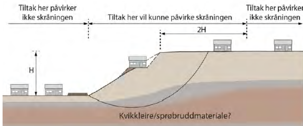
Figur 20. Utklipp fra NVEs veileder 1/2019 som viser prinsipp for når en skråning kan vurderes som upåvirket av tiltak.
