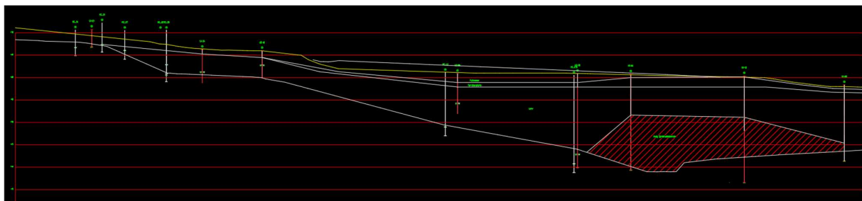
Figur 4-9: Profil C-C, b=0\text{m} antatt sprøbruddmateriale ligger såpass langt under skråning at det ikke er fare for områdeskred
