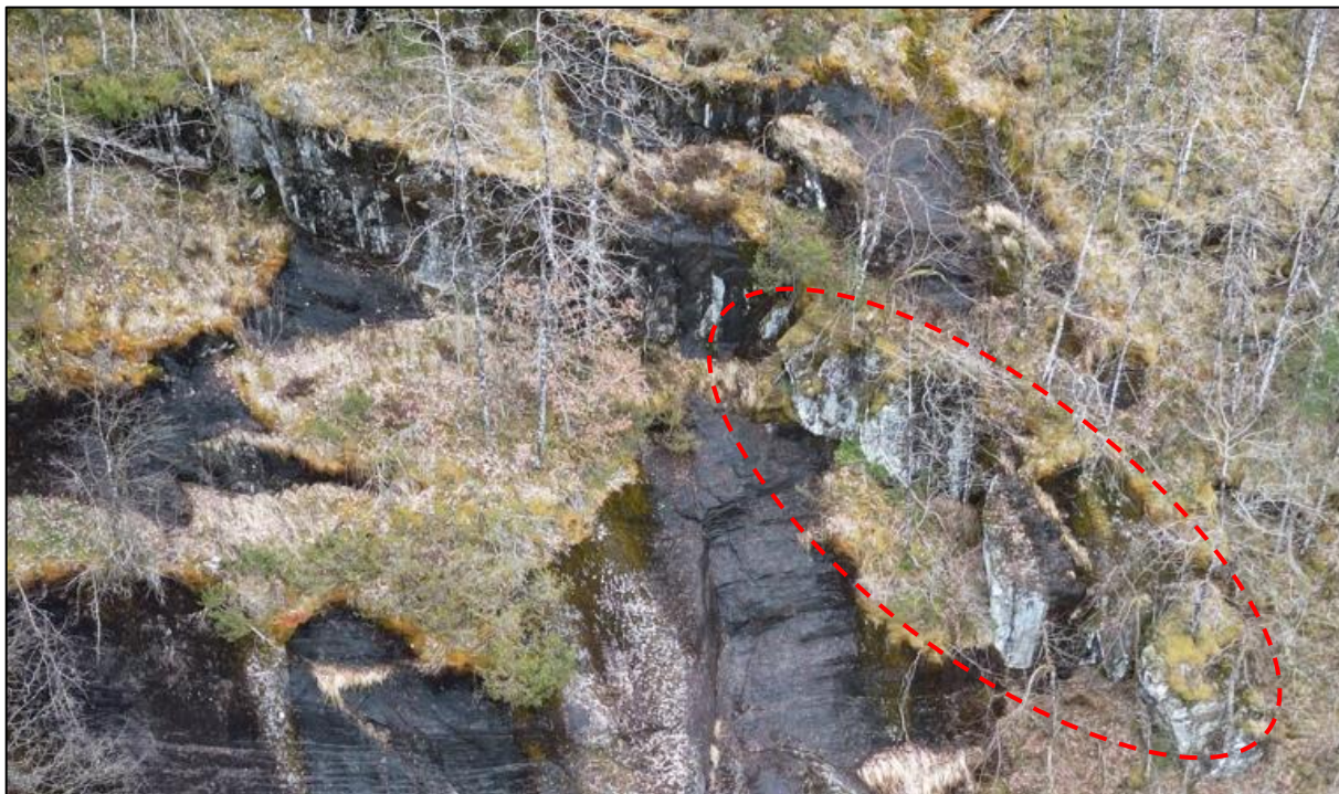
Figur 7: Flere mulig avløste blokker i skrenter over den nordlige delen av tomta, sett mot øst.
