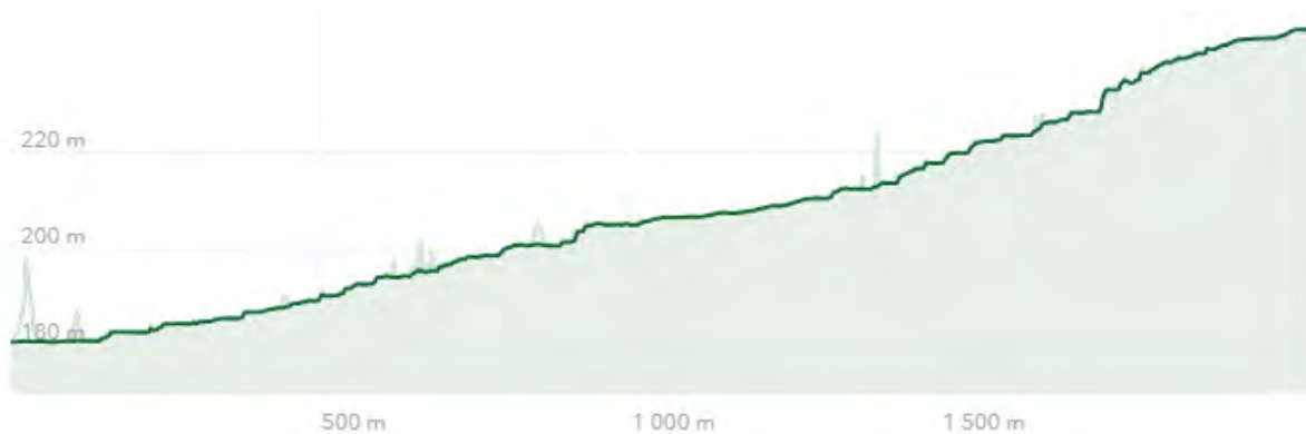
Figur 44. Terrengprofil generert fra www.hoydedata.no viser at de øverste to km av vurdert strekning av Flatdalsåi har en relativt betydelig fallgradient (gjennomsnittlig ca 3,2 %).
