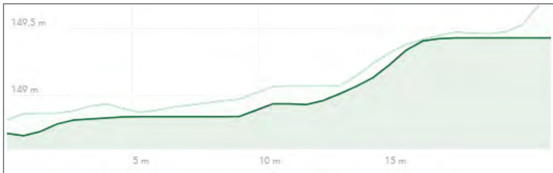
Figur 13. Løsmasseterskel ved Flatin tar ut et fall på om lag 0,4-0,5 meter, basert på terrengprofil generert fra Høydedata.no.
