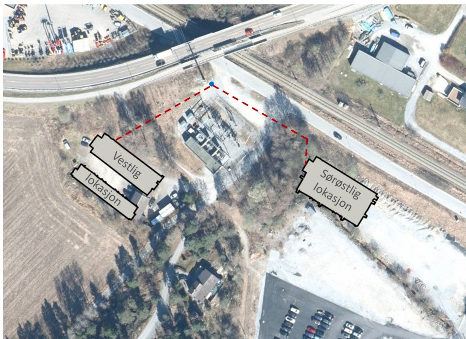
Figur 2-1: Oversikt over vurderte lokasjoner og stasjonsløsninger, hvor samlet løsning er illustrert for sørøstlige tomt og delt løsning for vestre tomt. Ny mast er indikert med blå prikk, og jordkabel fram til ny stasjon er indikert med stiplet, rød linje.
