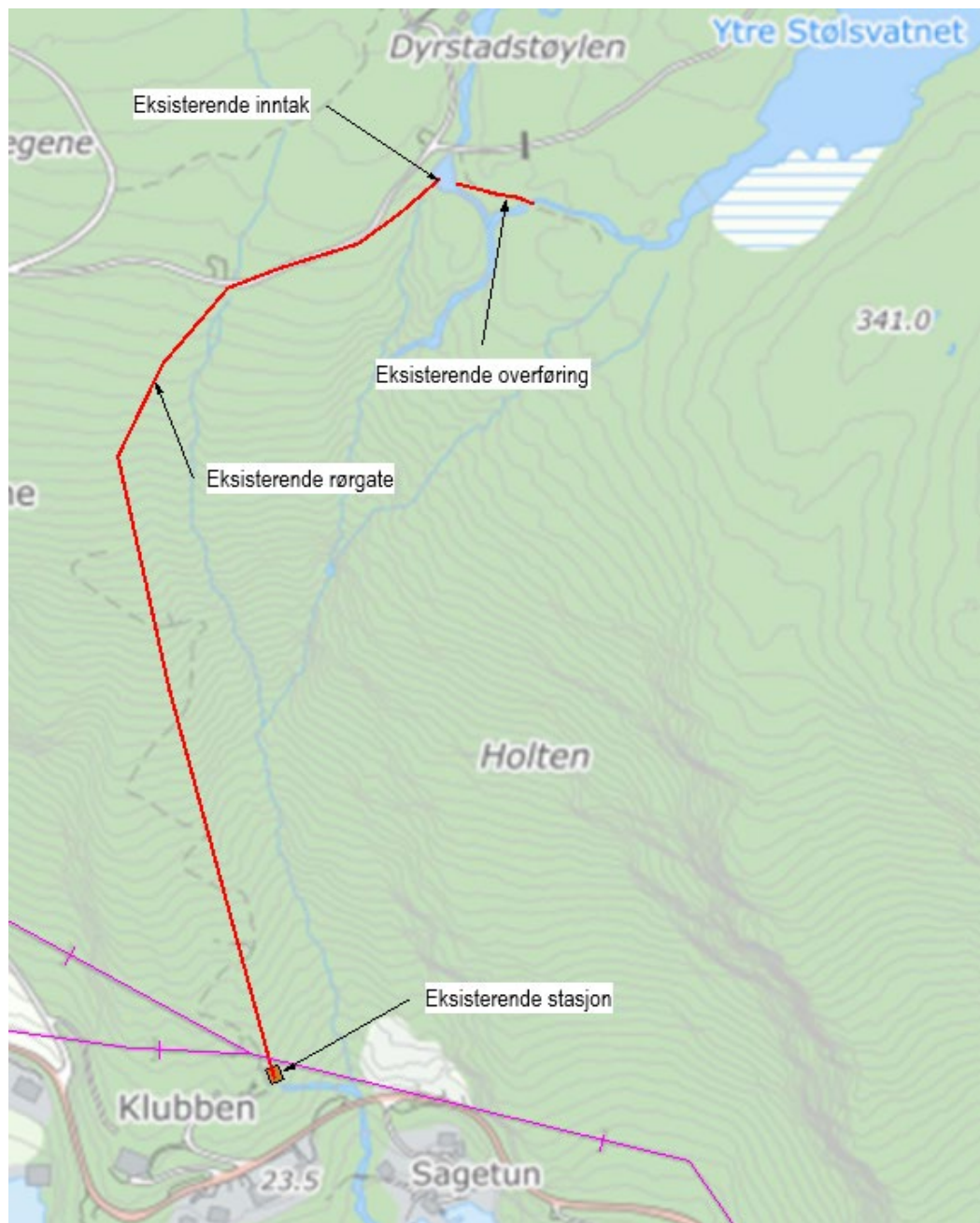
Figur 1-4: Oversikt eksisterende Dyrstad Kraftverk
