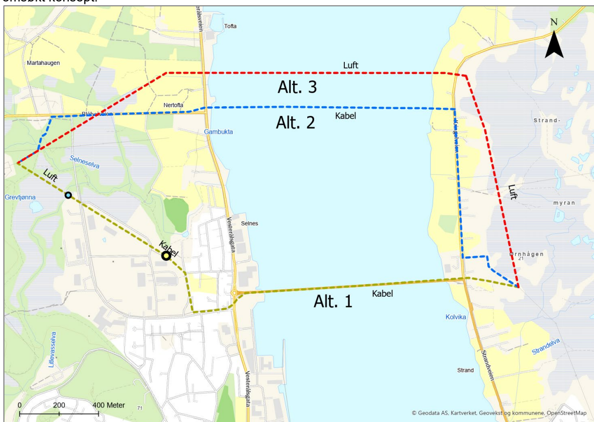
Figur 13 Oversikt over alternative konsepter for kryssing av Sortlandsundet. Alternativ 2 er utgangspunkt for den omsøkte løsningen.
