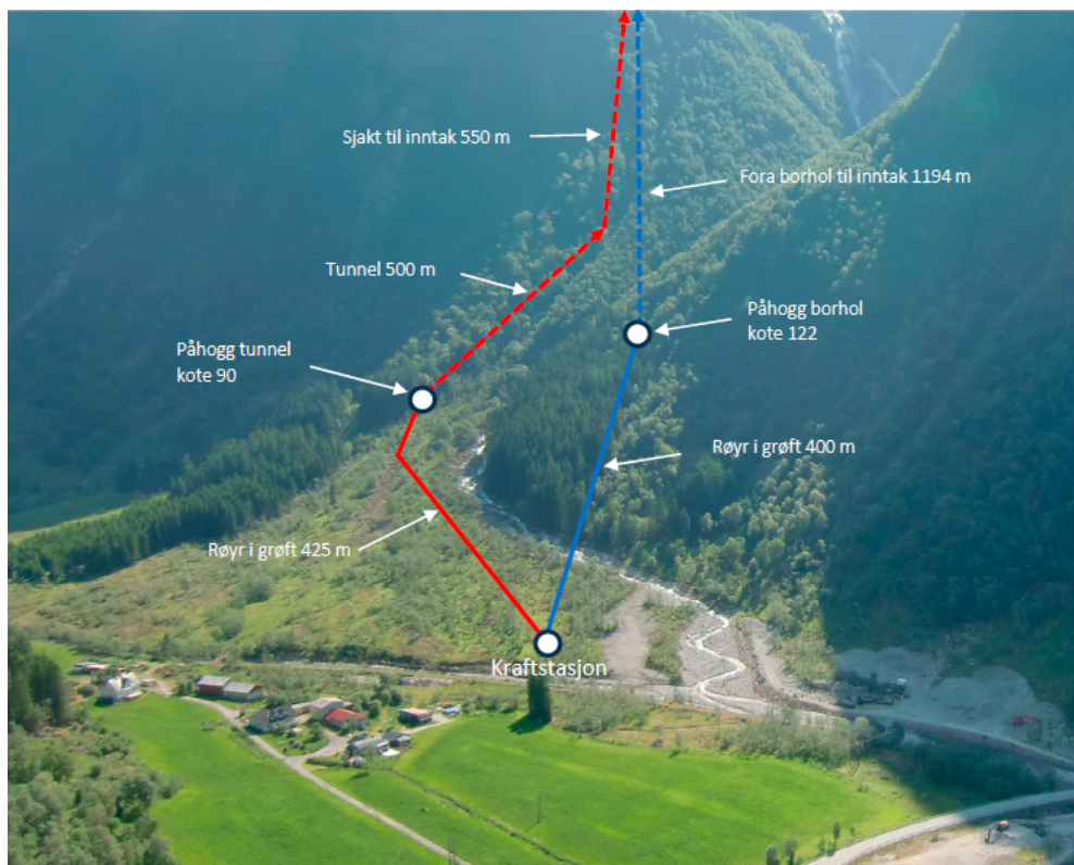
Figur 1: Konsesjonsgitt (rød) og justert (blå) rørgatetrasé. Referanse: tilleggsinformasjon til detaljplan (NVE-referanse: 202314119-8).
