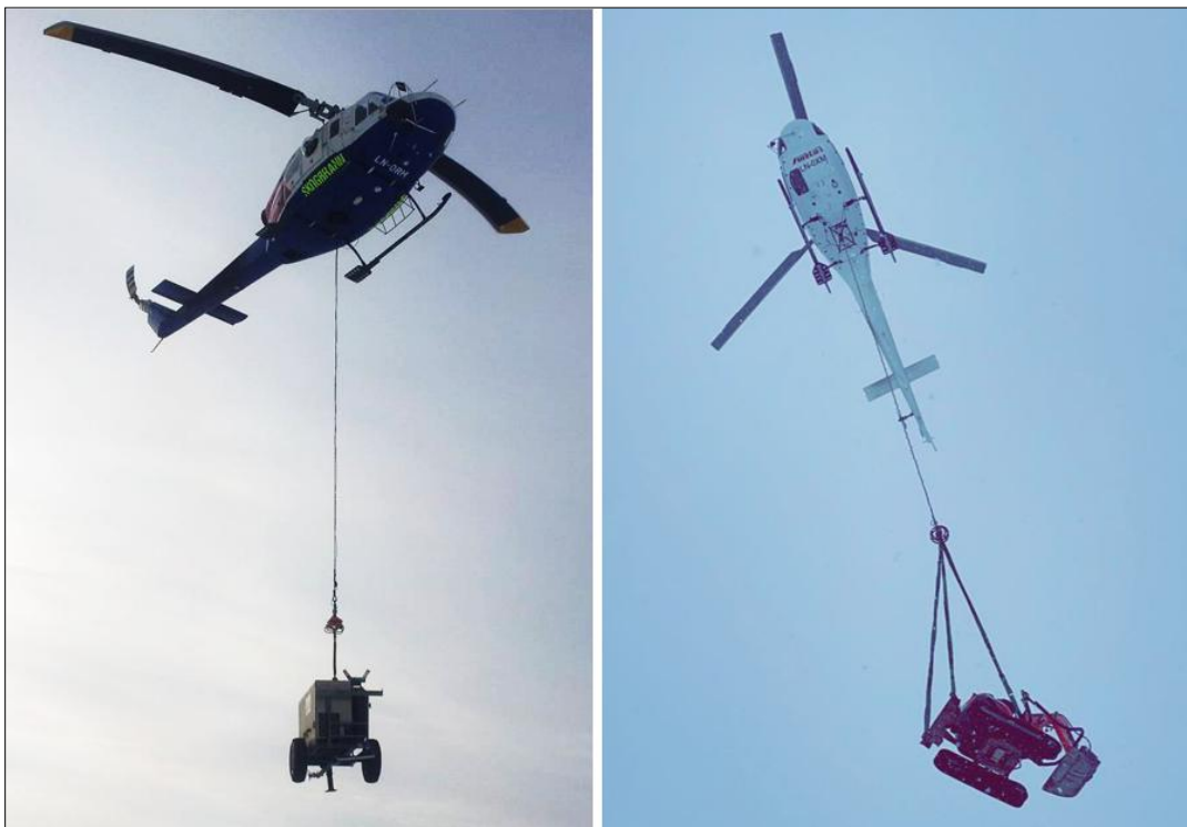
Figur 149 Eksempel på frakt av utstyr med helikopter. Bilder fra Br Hals AS
