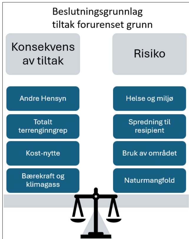
Figur 72 Modell som viser kriterier som bør inn i beslutningsgrunnlaget før endelige tiltak bestemmes pr mastepunkt med forurenset masse. Modell: Torsjon AS
