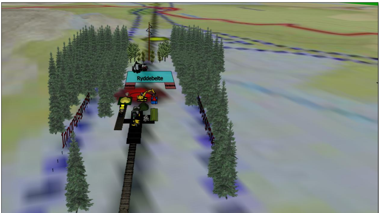
Figur 117 Inngrepsgrense i anleggsfasen er markert med blå stiplede linje i vedlagte kart. På visualiseringen vises det hvordan anleggsarbeidet pågår innenfor inngrepsgrensen. I bakgrunnen ser man at også skogrydding skjer innenfor inngrepsgrensen. Ryddebelte på 25m er smalere enn inngrepsgrensen. Skisse: Torsjon AS
