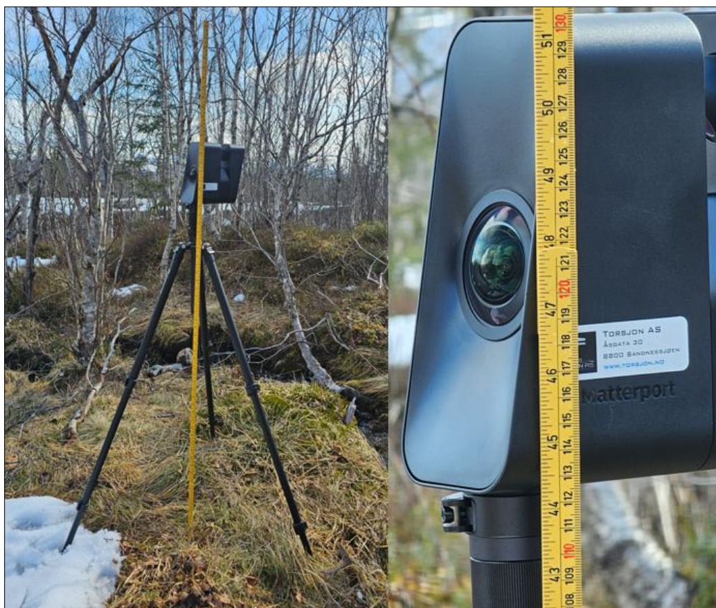
Figur 41 Bilder fra 3D skanning utført av Torsjon AS av identifiserte områder fra NIBIO. Skanning utført i april 2024 når snøen var smeltet, og før det kom blader på trærne. Dette for å gi et godt representativt bilde av de faktiske forhold.
