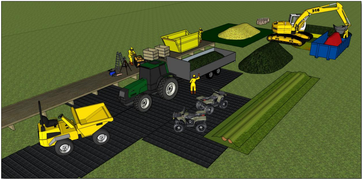
Figur 183 Eksempel på hvordan treplattinger og skytematter kan benyttes for å skåne underliggende myr. Kreosotholdig trevirke har presenning over og under. Visualisering: Torsjon AS
