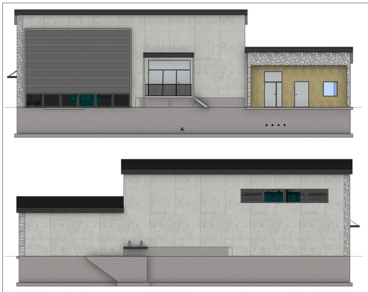
Figur 110 Fasader som også viser det som er under bakkenivå. Skisse: Torsjon AS
