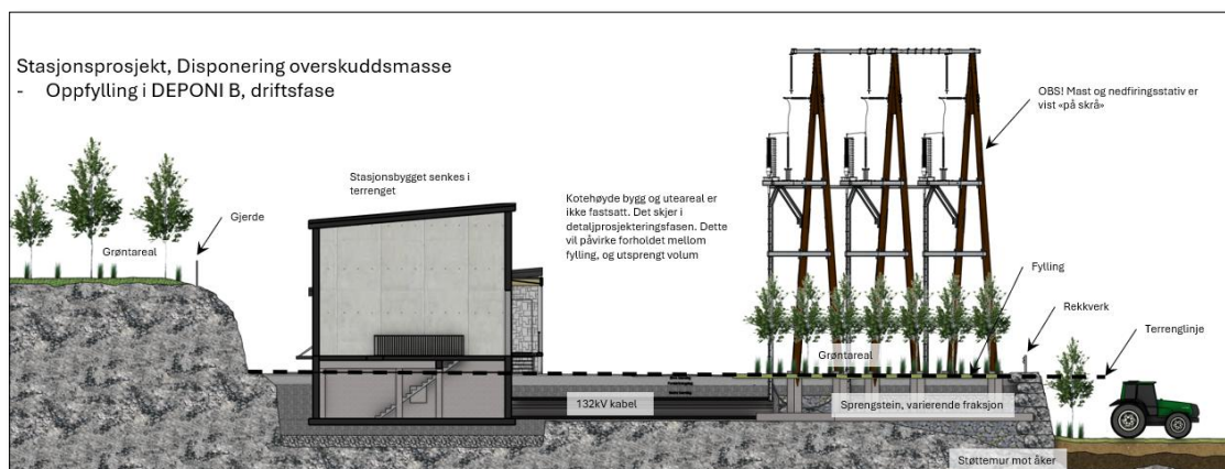
Figur 197 Prinsippkisse som viser snitt ved stasjonen i driftsfasen. OBS! Masten er skråstilt i denne visualiseringen. Skisse: Torsjon AS
