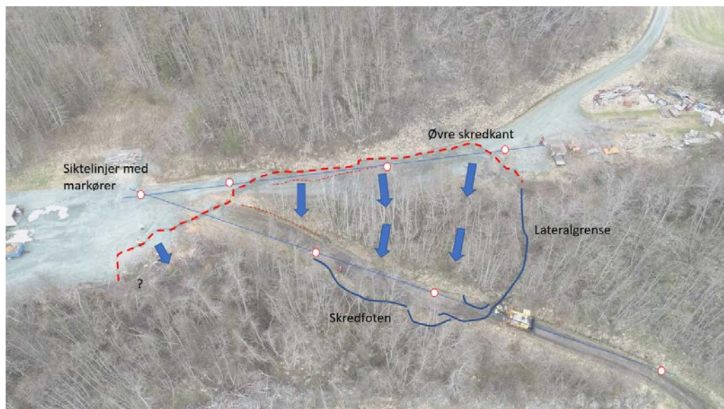
Figur 2 Dronebilde tatt av NVE 28.04.2020 med tolkning av øvre skredkant, ca. plassering av skredfoten og siktelinjer med markører for å kartlegge bevegelser. Antatt bevegelsesretning er vist med blå piler.
