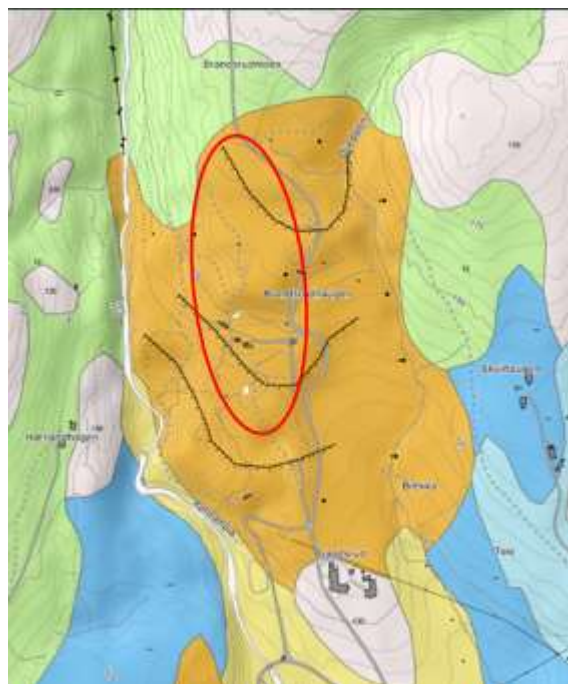
26 Kart fra NGU (Løsmassekart) viser tre terrassekanter i landskapet. Motorsportklubben har brukt terrassekantene til bratte kjøreruter, og de er stedvis forringet pga grus- og sanduttak. Tiltaksområdet er vist med omtrentlig avgrensning med rød strek.
