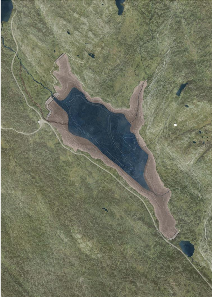
Figur 3. Viser alternativ C.2 med 5 meter senking av vannstanden i Storevatnet. Utløpet er plassert ved dagens bunntappeløp, som antas å være det opprinnelige utløpet.
