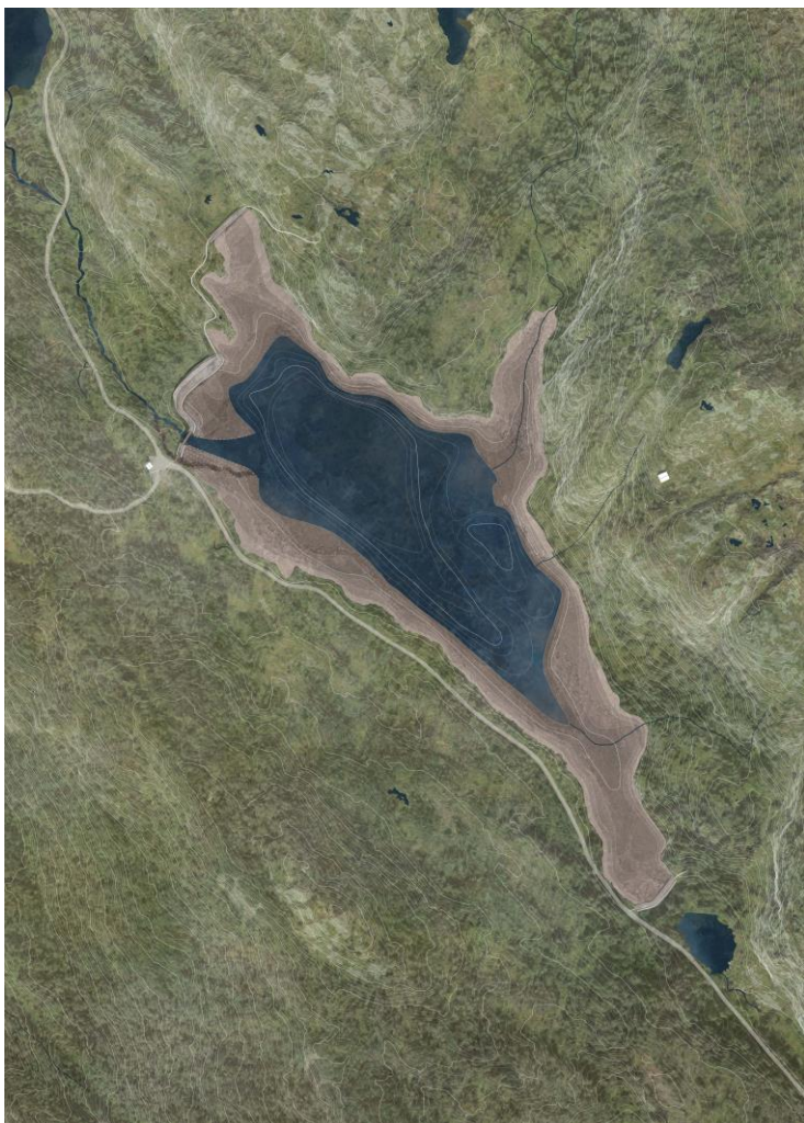
Figur 4. Viser alternativ C.1 med 5 meter senking av vannstanden i Storevatnet, hvor utløpet er plassert der dagens utløp er. Grunnet usikkerhet knyttet til bunnforhold kan det bli behov for graving/sprenging for å etablere et utløp her.
