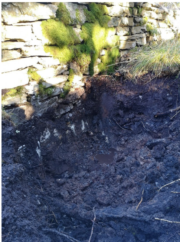
Bilde 6. PG2. Vann fra dam/magasin inn i prøvegrop.
