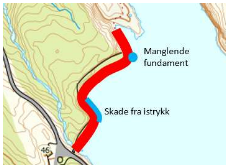
Figur 5: Skader på dam/mur 1, markert med blått.
