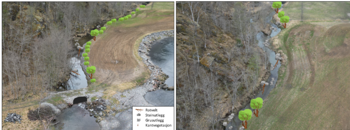
Figur 6-7: Prinsippskisse for tenkte habitattiltak i midtre del av Øvelandsgrovi. Kantvegetasjon, steinutlegg og noen rotvelter vil gi økt skjul og mer variasjon i strømming. Kantvegetasjon vil samtidig fungere som buffersone for avrenning fra landbruket. Dronefoto: Hydro Energi AS.
