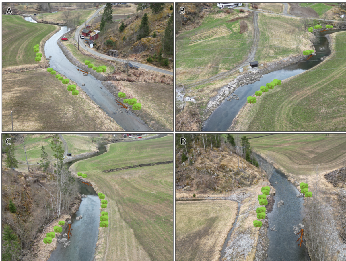
Figur 6-4: Prinsippskisser for habitattiltak i Haugelvi. Hensikten er å gjenskape mer variasjon i strømning og bunnforhold, gjenetablere kantvegetasjon og generelt bryte opp en ellers steril kanal. Tiltakene vil gjenopprette Haugelvi som et viktig oppvekstområde for fisk. Dronefoto: Hydro Energi AS
