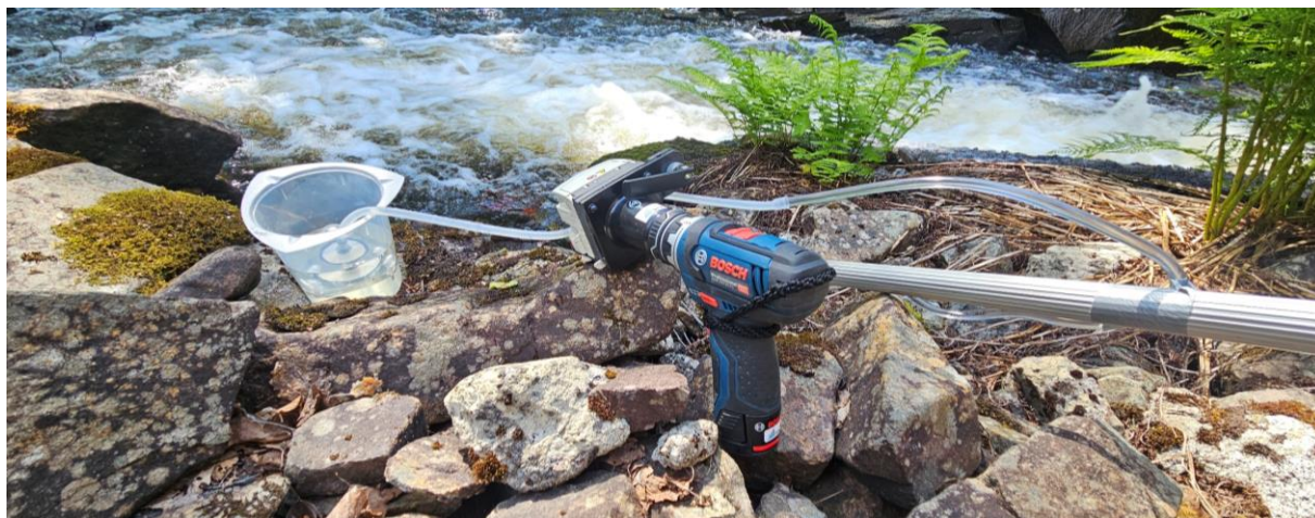
Figur 2-1. Oppsett for å pumpe vann og måle mengden vann som filtreres. Foto: Multiconsult ASA
