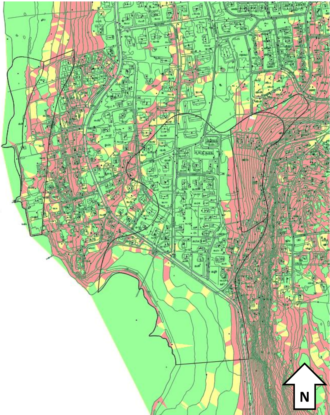
Figur 3-1: Resultat fra terrengeanalyse som indikerer terrenghelning. Grønt illustrer helning < 1:20, gult illustrer helning mellom 1:20 og 1:15. Rødt illustrer helning brattere enn 1:15. Tidligere soner er markert med sort omriss.
