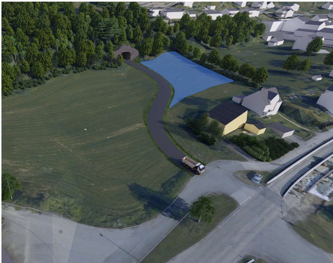
Figur 10 Mellombels veg og riggområde på Ilflaten i samband med tunnelpåhogg til Tysso kraftverk på Ilflaten, kilde: COWI.
