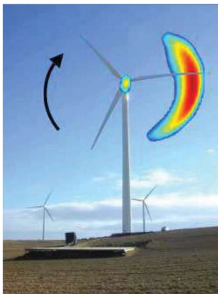
Figur 4: Visualisering av lyd fra en vindturbin. Mest lyd fra rotorbladet ved nedgående retning. Kilde S. Oerlemans, 2009
