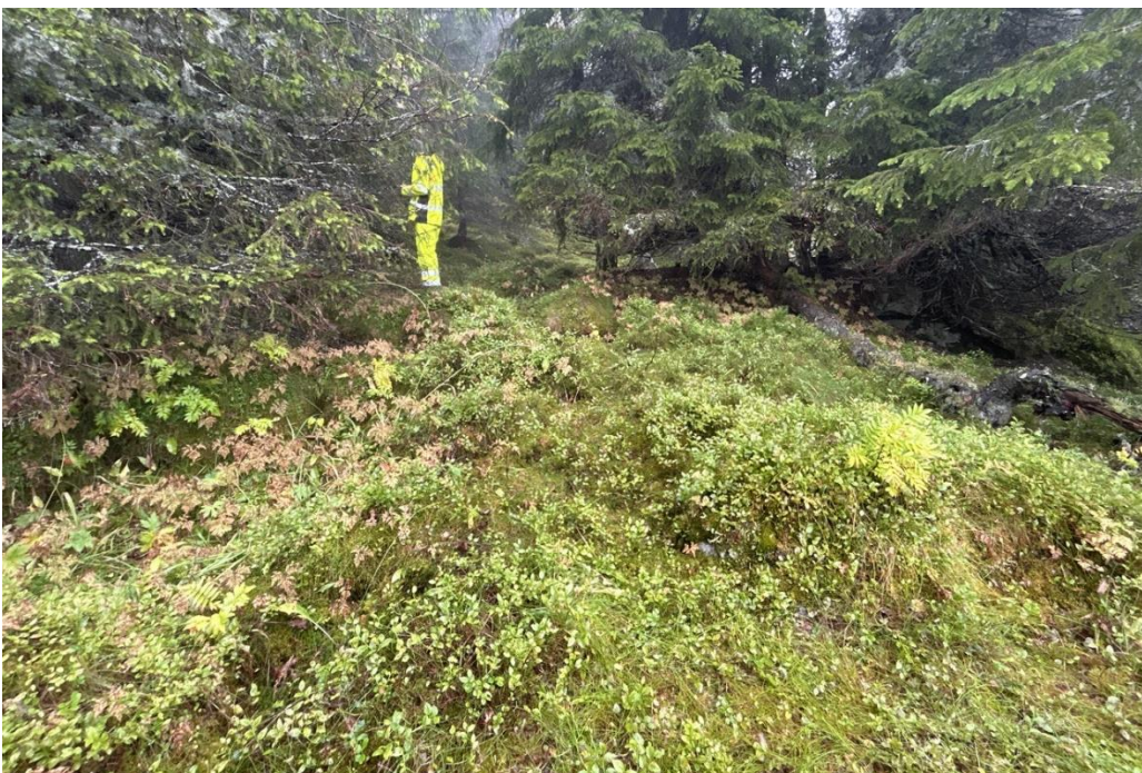
Figur 3-27: Foto av mastepunkt M220. Tynt torvdekke over berg.
