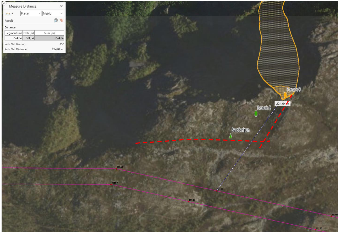
Figur 2-10: Ustabil fjellparti 225 m nordøst for mastepunkt M208. Flyfotoet viser et større avløste parti i nær tilknytning til «Scenario C». Rett nord for mastepunkt 11 er det antydning til en svakhetszone som går øst-vest, og som kan være avløsende for et > 5000 års fjellskred. Røde stiplede linjer indikerer svakhetssoner.
