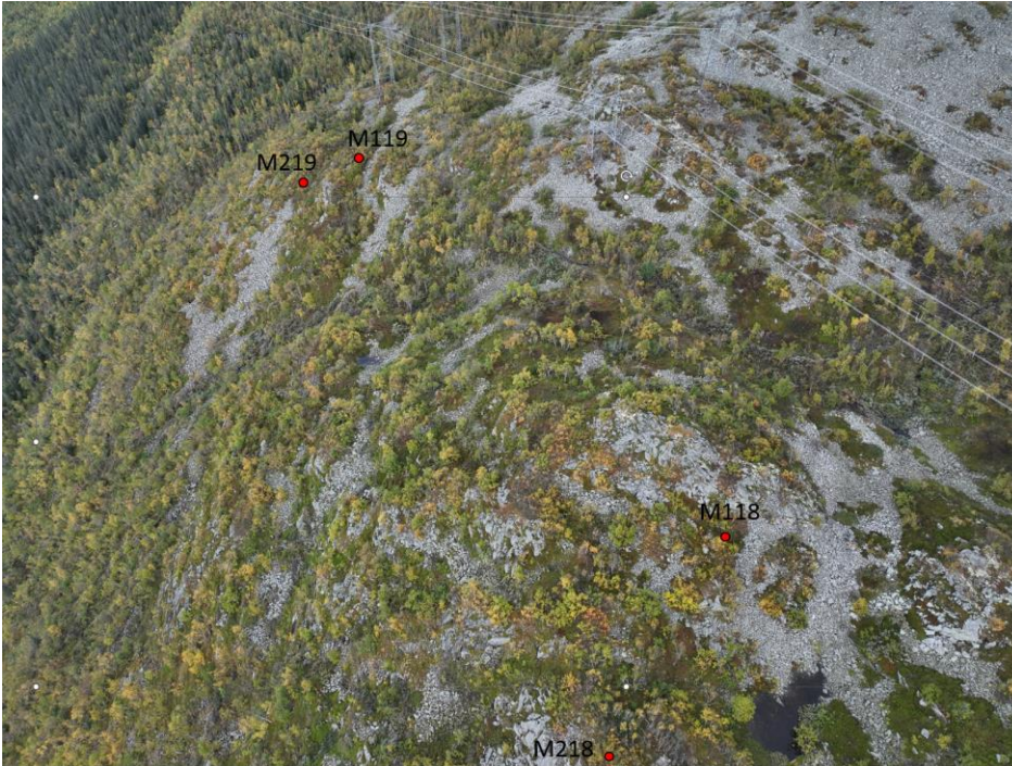
Figur 3-26: Foto av mastepunkt M118-M119 og M218-M219. Punkt M119 og M219 ligger nærmest på bart fjell, med noe omkringliggende forvitningsmateriale og torv.
