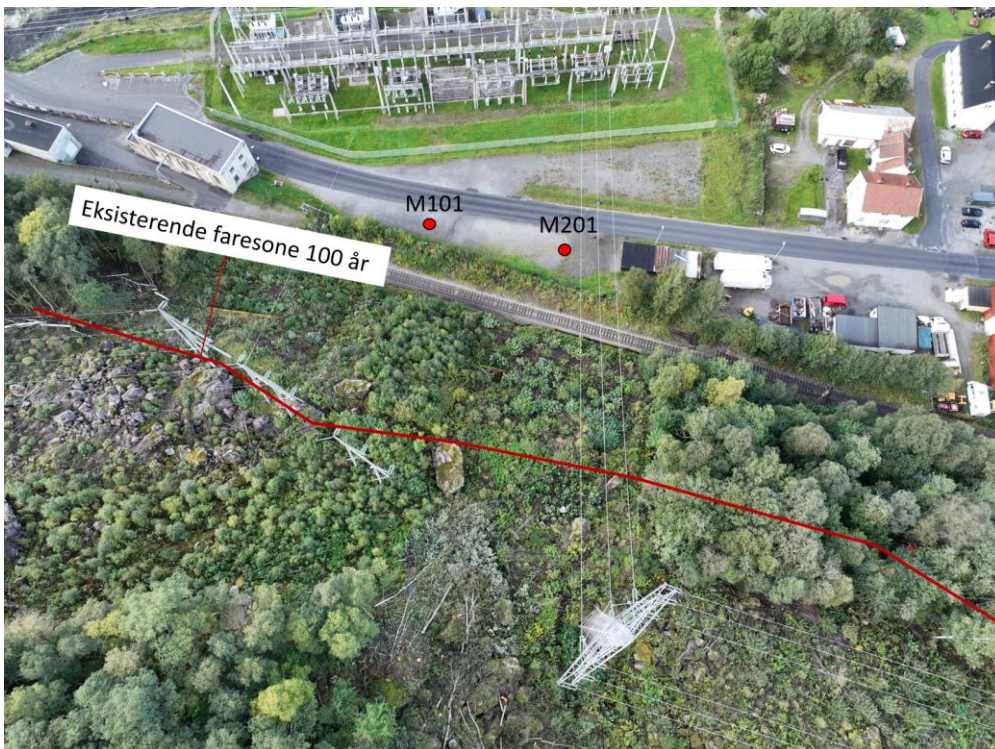
Figur 3-2: Rasur og eksisterende faresone 100 år ovenfor toglinja. Det er ikke observert tegn til fersk steinsprangaktivitet.
