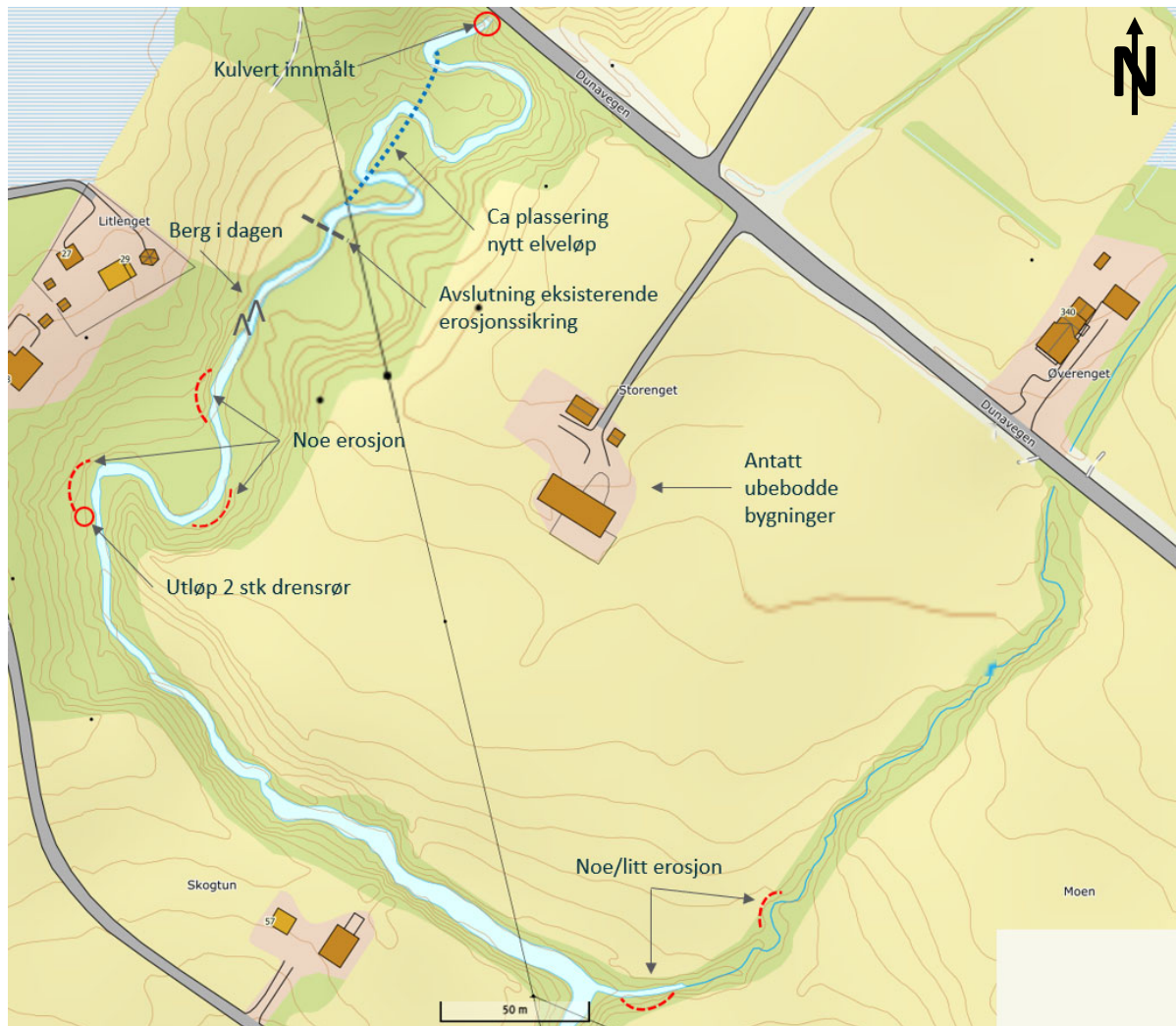
Figur 2-2 Kart med observasjoner fra befaring, nedstrøms kulvert ( www.norgeskart.no )
