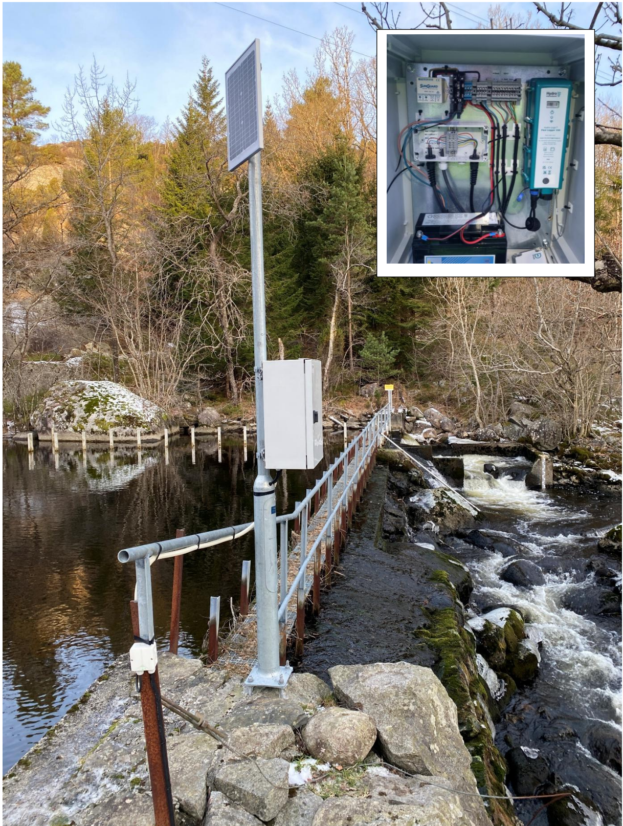
Vedlegg 1c: Eksempel på målestasjon for registrering av minstevannføring. Utstyrt med solcelle.
