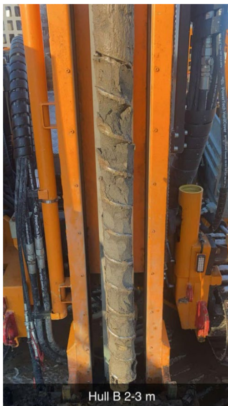
Bilde 3.3 Borpunkt B. Dybde 2-3 m. Sand.
