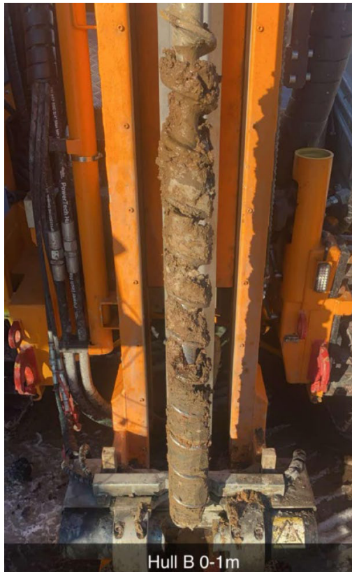
Bilde 3.1 Borpunkt B. Dybde 0-1 m. Sandig leirig matjord.
