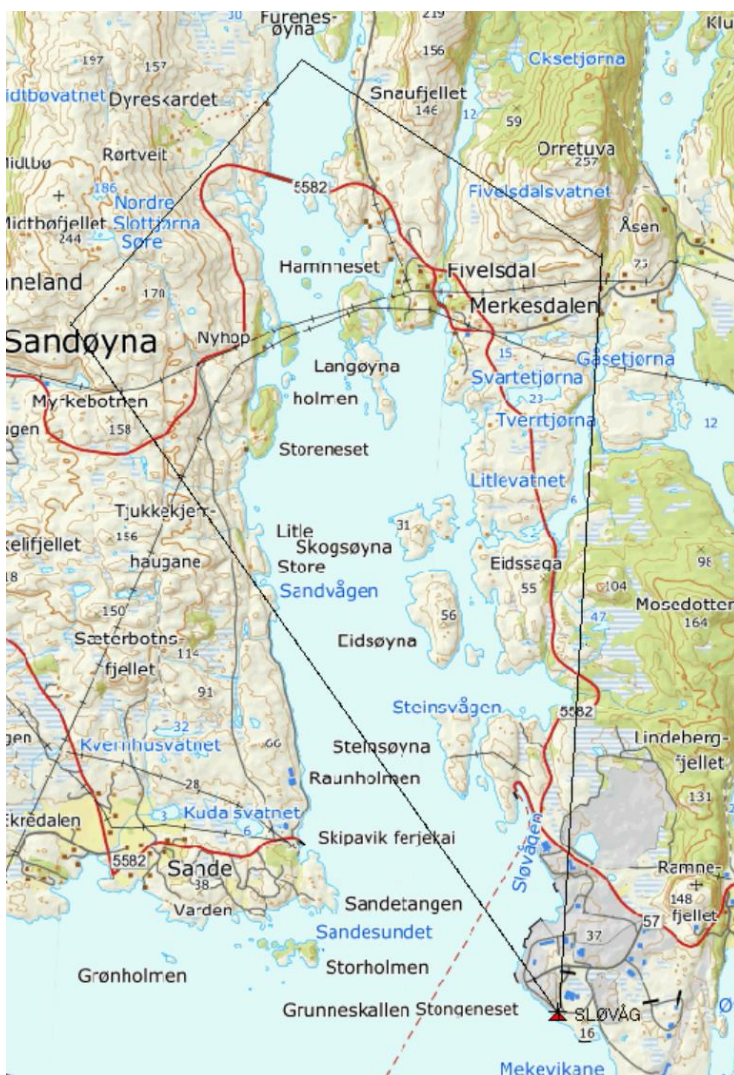
Figur. Geografisk område (markert trekant) som anses mest utsatt for «Forward scatter» fra Ulriken hovedsender i Bergen. Markert område er ca. +/- 20 grader ut fra senterlinjen fra hovedsender på Ulriken i Bergen til Sløvåg.
