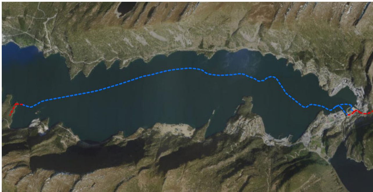
Figur 2-1. Oversiktskartet viser kabeltrasé fra Holmaneset til Svelgen. Sjøkabel er vist med blå stiplet linje. Jordkabler er vist med rød stiplet linje.
