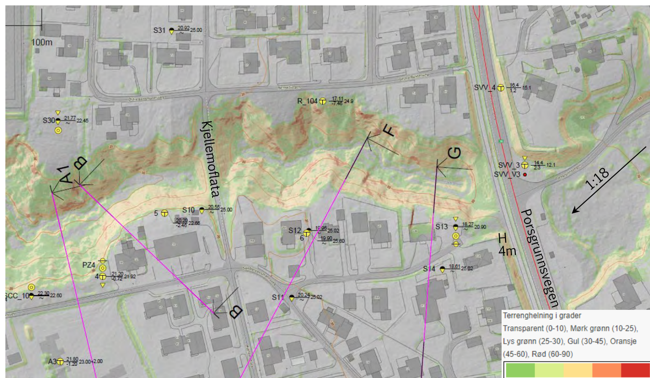
Figur 3. Utklipp fra Høydedata, med helningskart, utførte grunnundersøkelser og aktuelle profiler.
