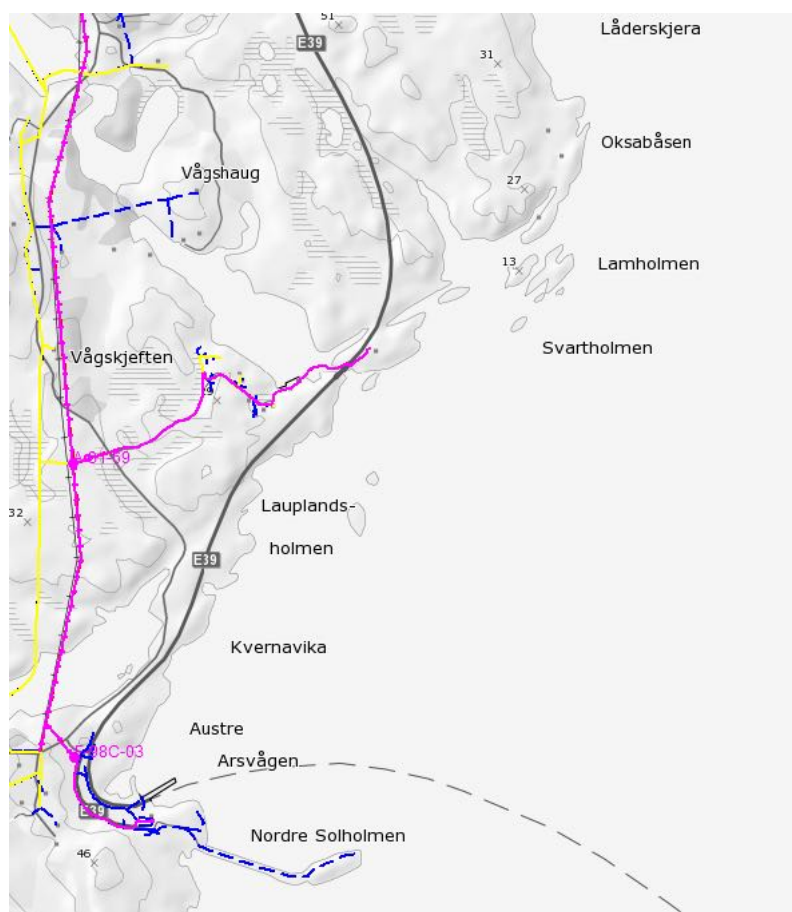
Figur 6. 22 KV nettforbindelse med god kapasitet (lilla)
