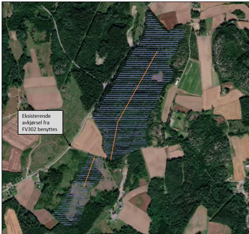
Figur 6 Skisse av panelrader (blå) og internveier (oransje) i solkraftverket.
