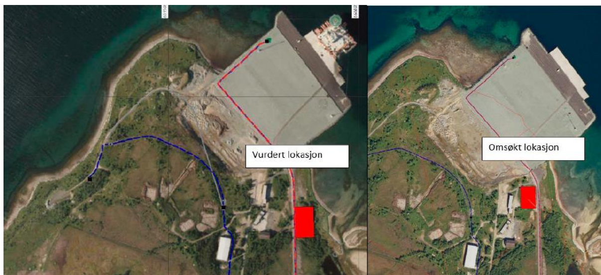
Figur 6: Vurdert og omsøkt plassering av Grøtsund transformatorstasjon. Vurdert plassering lå innenfor aktsomhetsområde for stormflo.
