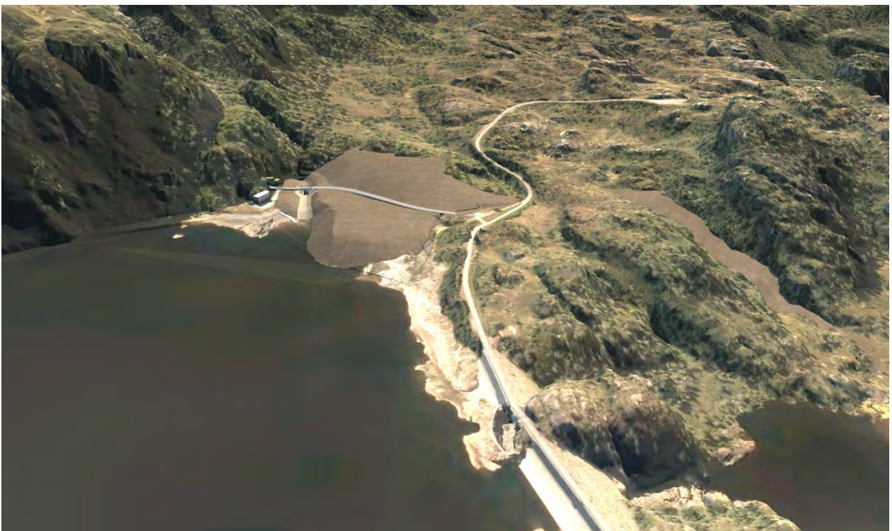
Figur 3-40. Utklipp fra modell. Plassering av portal og deponi Staffivatn øst og vest. Modellen viser kun hovedformen, og detaljer som variasjoner med forhøyninger og forsenkninger fremkommer ikke i modellen.
