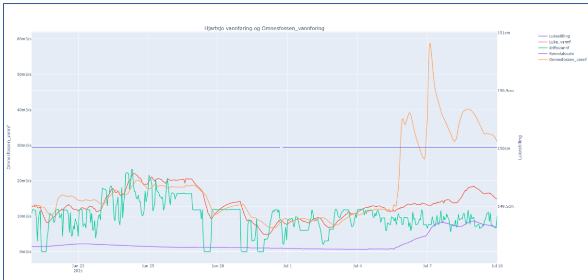
Figur 7 viser driftsmønster med luken liggende fast nede og dempingen vi får av magasinkapasiteten og innsnevring gjennom luke åpning i Hjartsjø dam sommeren 2021.
