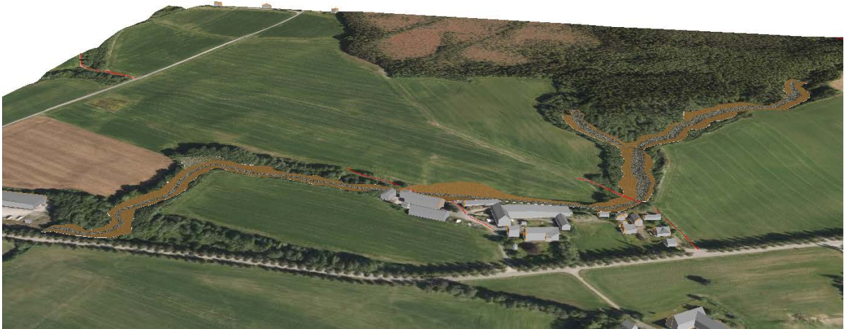
Bilde 2: Oversikt over tiltaksområdet. Erosjonssikringen er modellert som brune masser. Bekkebunnen er spraglete svart/hvit.
